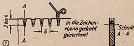
noch als Lötösen verwenden. In den Isolierstoff (z. B. Pertinax 3 mm stark) werden etwa 1 mm. große Löcher gebohrt. Abstand vom Rande 3 ... 4 mm, Abstand der Löcher untereinander  $\geq 6$  mm. Um den Ösen den nötigen Halt zu geben, werden mit einer Dreikantfeile von beiden Seiten Nuten eingefeilt. Der Draht wird durch die Bohrung gesteckt, scharf in die Nuten gedrückt und mittels einer Flachzange einmal herumgedreht, die freien Enden zu Ösen gebogen.“
