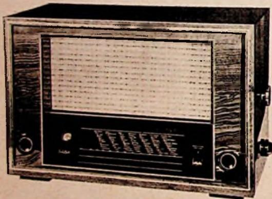
7 Röhren, 2fach unterteilter Kurzwellenbereich, Hochfrequenzvorstufe, regelbares Dreifach-Bandfilter, 3fach Schwundausgleich, Trennschärfe breit 1:80, schmal 1:1200, Empfindlichkeit auf allen Bereichen kleiner als 5  $\mu$ V.
